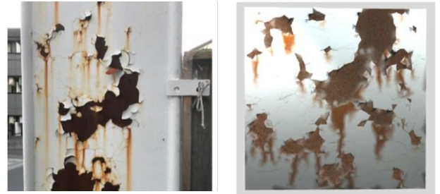
図1: 現実世界における塗膜の劣化(左)と提案手法を用いたシミュレーション結果(右)の比較
